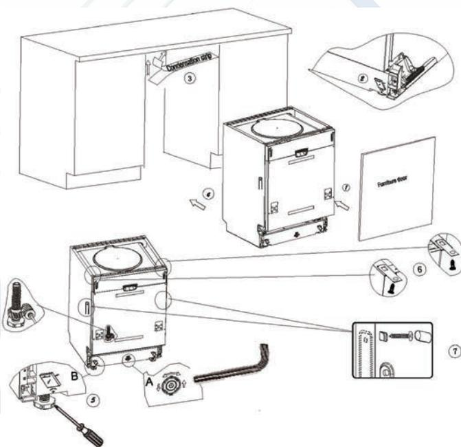
Положите на дверцу машины и внутрь кюветы уровень, чтобы проверить, ровно ли расположена машина. Выровняйте машину, регулируя каждую опорную ножку отдельно. Выравнивая положение машины, старайтесь не опрокинуть ее.
